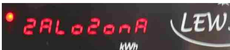
Rys. 9.4 Komunikat na wyświetlaczu po wprowadzeniu kodu aktywującego blokadę pokrywy listwy zaciskowej
