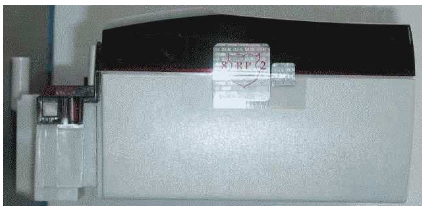
Rys. 2.6 Plombowanie przy użyciu naklejek
