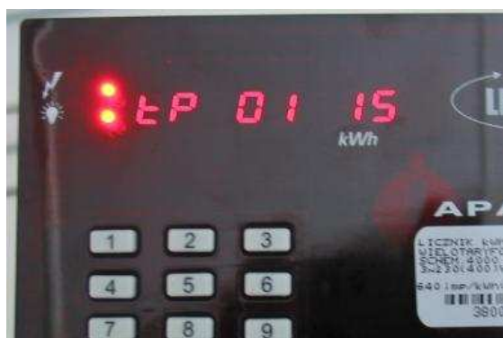
Rys 3.1 Ustawienie rejestratora mocy maksymalnej z 15-minutowym okresem uśredniania i zamykaniem okresu rozliczeniowego 1-go dnia każdego miesiąca
