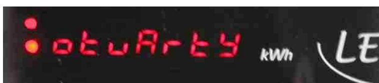
Rys. 9.5 Komunikat na wyświetlaczu po próbie założenie blokady przy niewłaściwie zamontowanej pokrywie listwy zaciskowej
